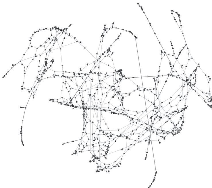
Рис. 2. Визуализация упрощенного неориентированного графа транспортной инфраструктуры г. Владимир на уровне асфальтированных дорог, наличия тротуаров, регулируемых перекрестков и т. п.
